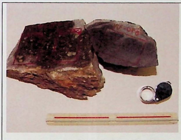
Figura 19 - As amostras que representam o grupo IV são VLF-07C1/C2. Ao lado direito, amostra VLF-07B, a borda básica, que torna o dique composto.
